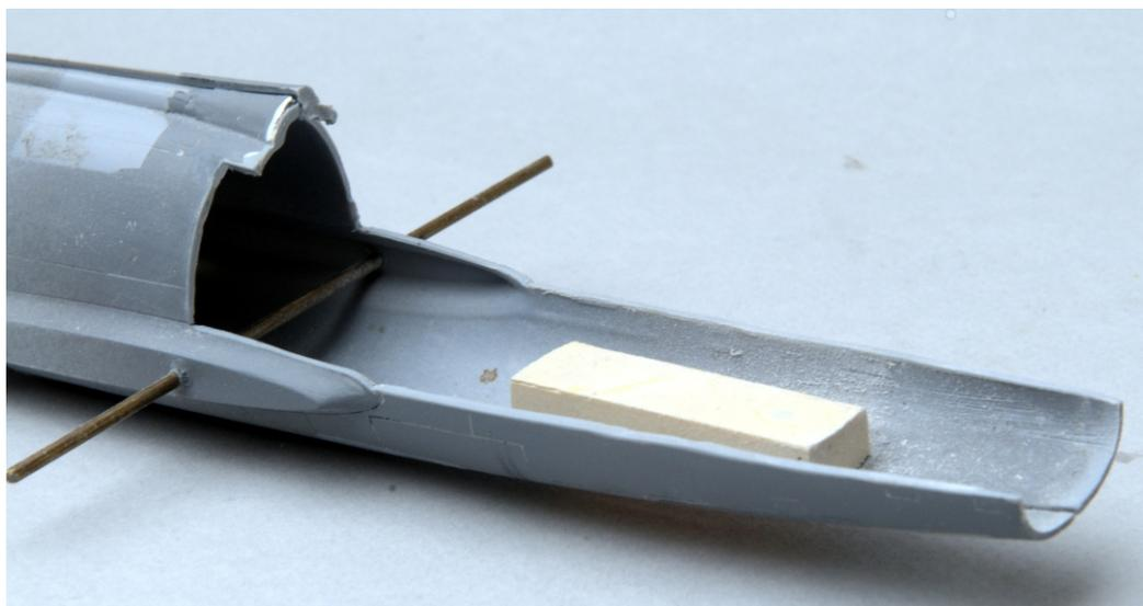
Découpez l'emplacement du nez à l'aide d'un scalpel chauffé à la bougie, ou, si vous possédez un fer à souder de faible puissance (10-15W), "ficelez" une lame de scalpel sur la panne au moyen de fil de laiton..
