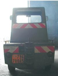
La partie arrière de la cabine se démonte et ne laisse en place que le pare brise. Cette version «été» est celle du kit
